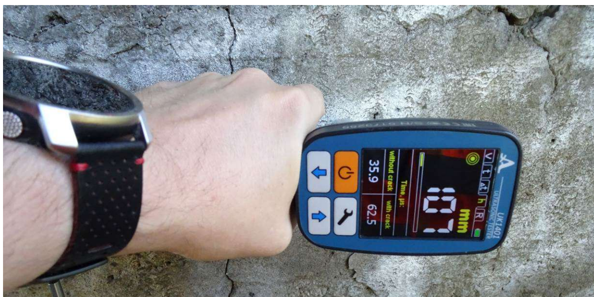
Rys. 1. Zasięg rysy 107 mm. Rozwarcie 0,6 mm
